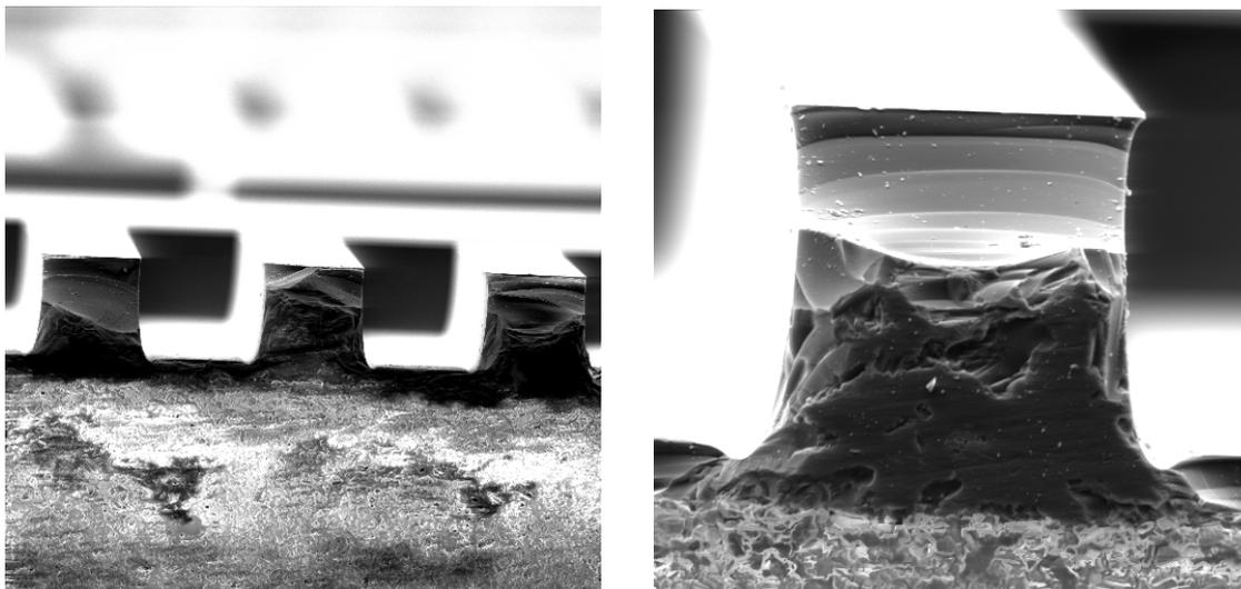
**Abbildung 4.15.** Kantenbildung in dicken DNQ-Lackschichten: REM-Aufnahmen des Lacks AZ 4562.
