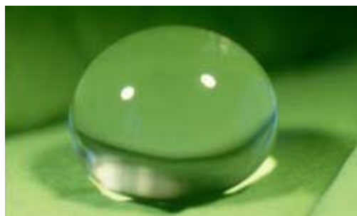
Abb. 13: Ein Flüssigkeitstropfen auf einer superhydrophoben Oberfläche [6]
